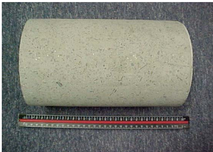
Obr. 29 Jádrový vývrt ze stříkaného drátkobetonu
