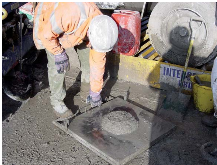
Obr. 28 Provádění zkoušky rozlítí
