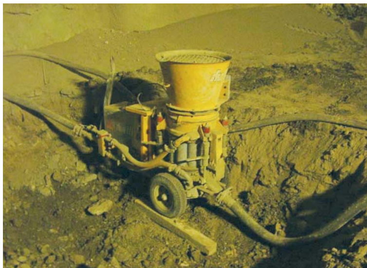
Obr. 35 Stříkací stroj pro nástřik suchou cestou
