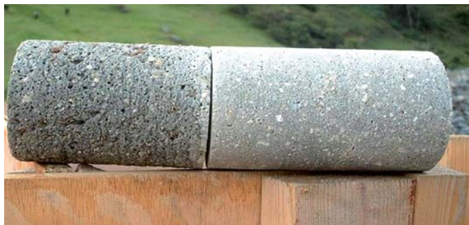
Obr. 23 Vliv způsobu nástřiku na kvalitu ostění (betony zhotoveny ze stejné betonové směsi za stejných podmínek různými operátory trysky)
