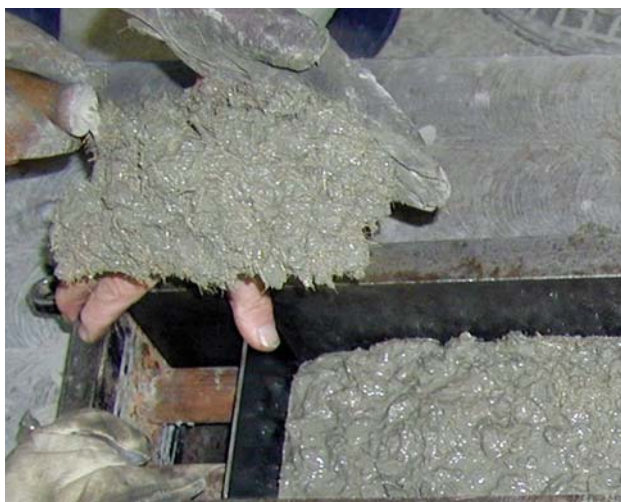
Obr. 5 Mokrý směs pro stříkaný beton s polypropylenovými vlákny
