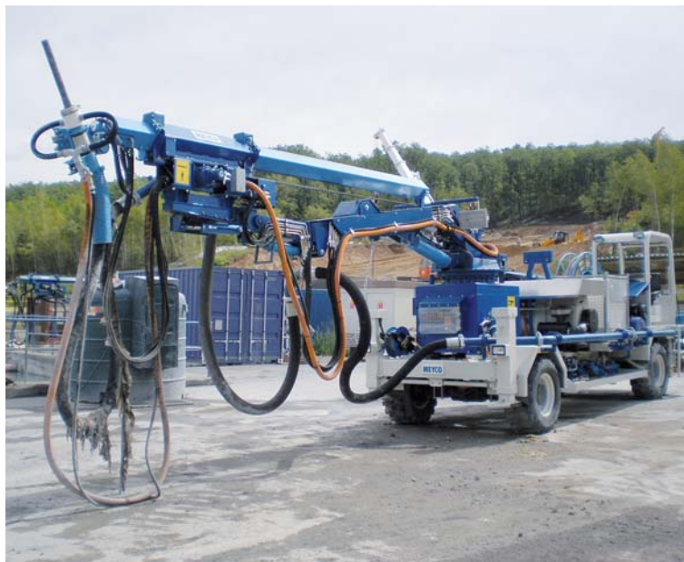
Obr. 38 Strojní sestava pro stříkaný beton
