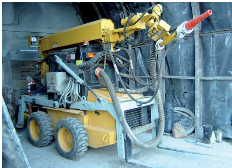
Obr. 37 Manipulátor pro malé profily (štoly a propojky)
